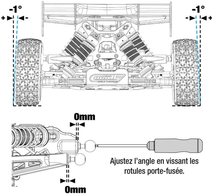
Ajustez l'angle en vissant les rotules porte-fusée.
